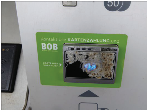
Abb. 38: Wie hier in Ritterhude waren an vier weiteren Stationen die Kartenlesefelder der NordWestBahn-Automaten angekockelt. Ob diese noch einwandfrei funktionierten, wurde nicht getestet.
