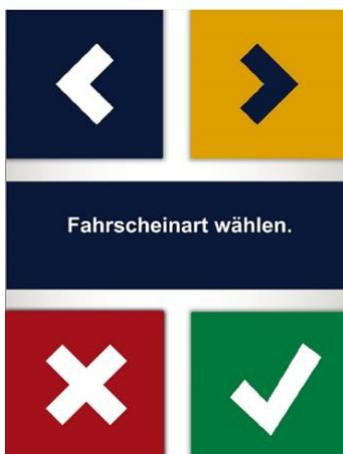
**Bild 51: Beispiel für eine auf wesentliche Funktionen reduzierte und vergrößerte Menüführung an einem Fahrkartenautomaten (Quelle: VAG Nürnberg)**
