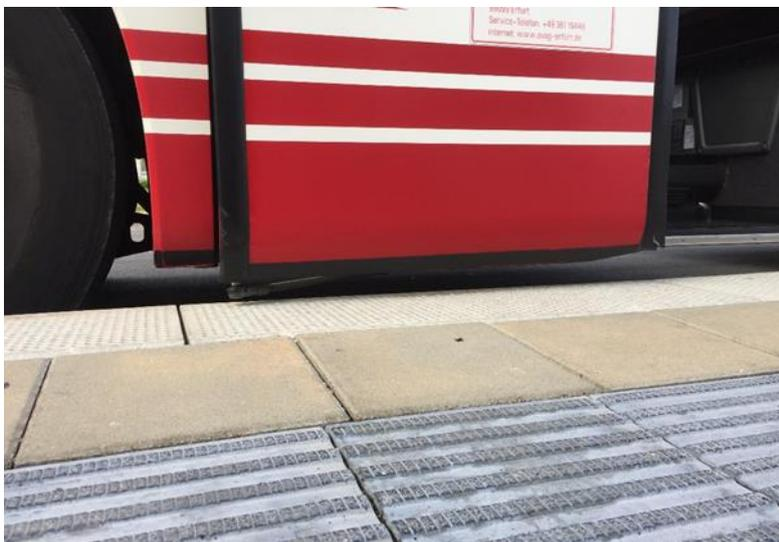
**Bild 5: Außenschwenktür mit unten angebrachter Führungsstange an einem hohen Busbordstein (hier 24 cm, Bus ist nicht abgesenkt) (Foto: Boenke)**
