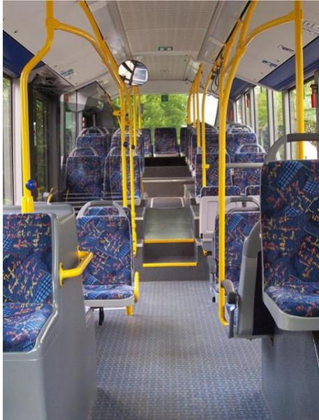
**Bild 30: Querstufen in einem Low Entry-Bus mit visuell kontrastierenden Stufenkantenmarkierungen (Foto: Von Martin Hawlich (LosHawlos) – Wikimedia Commons, lizenziert unter CreativeCommons-Lizenz by-sa-3.0-de, <http://creativecommons.org/licenses/by-sa/3.0/de/legalcode>)**
