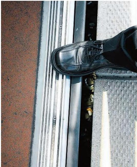
**Bild 11: Einstiegsleiste unterhalb der Tür zur Verringerung des Restspaltmaßes bei einer Straßenbahn (Foto: Kölner Verkehrs-Betriebe AG)**
