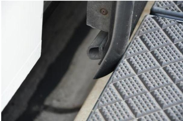
**Bild 4: Geöffnete Außenschwenkschiebetür mit Kontakt zum Bord (Höhe 22 cm) (Foto: ZVBN)**
