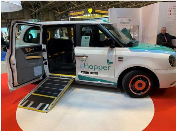
**Bild 46: Fahrzeug mit seitlicher Rollstuhlrampe für einen Einsatz im bedarfsgesteuerten Verkehr (Foto: Boenke)**
