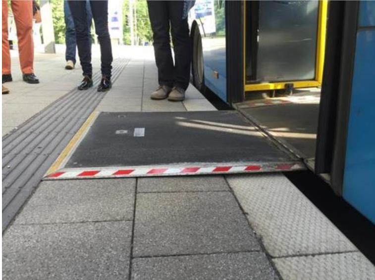
**Bild 16: Ausgeklappte Rampe bei gleichzeitig aktivierter Absenkfunktion des Busses an einem Busbordstein mit 22 cm Höhe (Foto: Boenke)**
