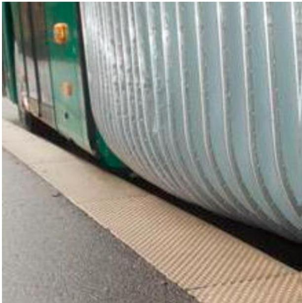
**Bild 54: Eingezogener Faltenbalg bei einem Gelenkbus als Weiterentwicklung (Foto: Christian Stocker-Arnet)**
