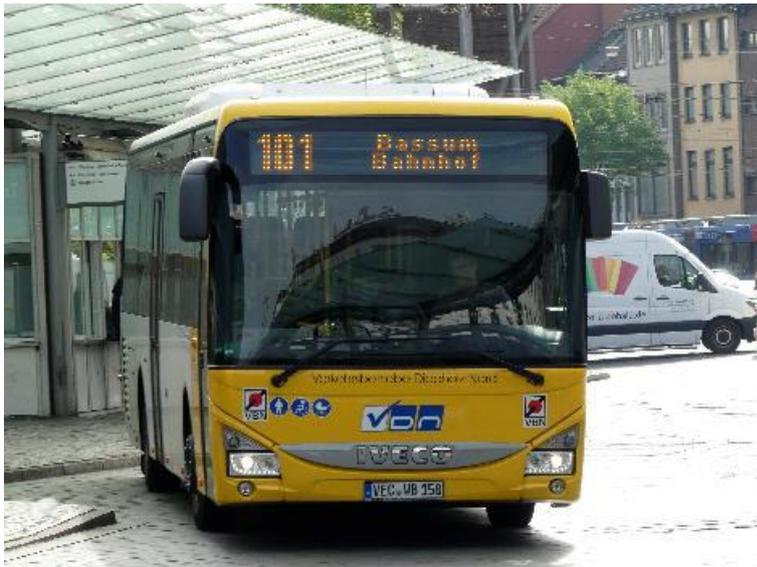
**Bild 18: Fahrtzielanzeiger mit positivem Kontrast an einem Bus im VBN (Foto: Boenke)**
