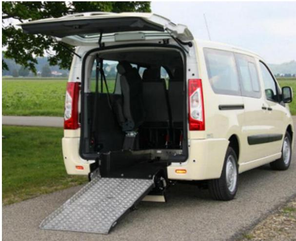
**Bild 45: Großraumtaxi mit der Möglichkeit der Mitnahme stehender Rollstühle über HeckEinstieg (Quelle: ZVBN)**
