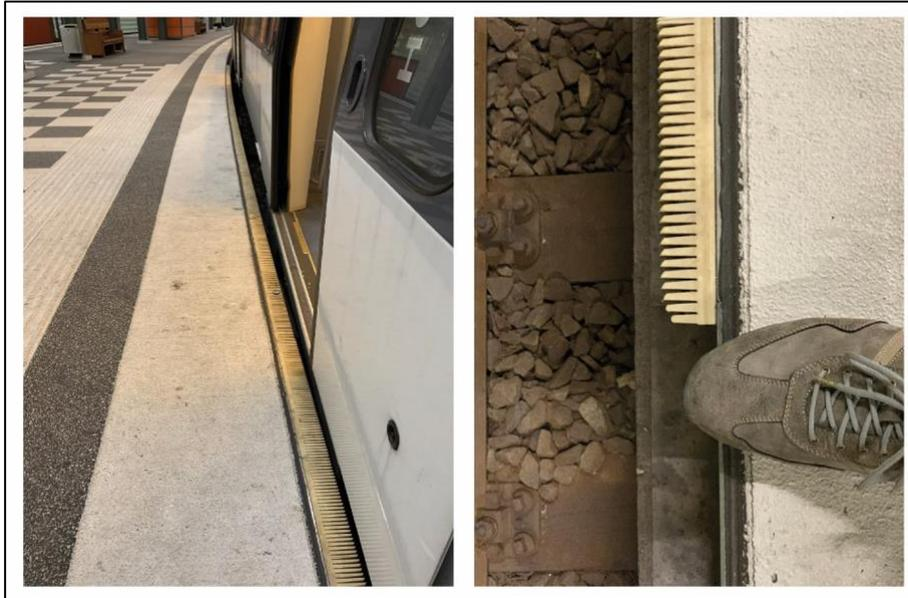
**Bild 10: „Gapfiller“ zur Reduzierung des Spaltmaßes bei Bahnsteigen in Kurvenlage (Fotos: Boenke)**
